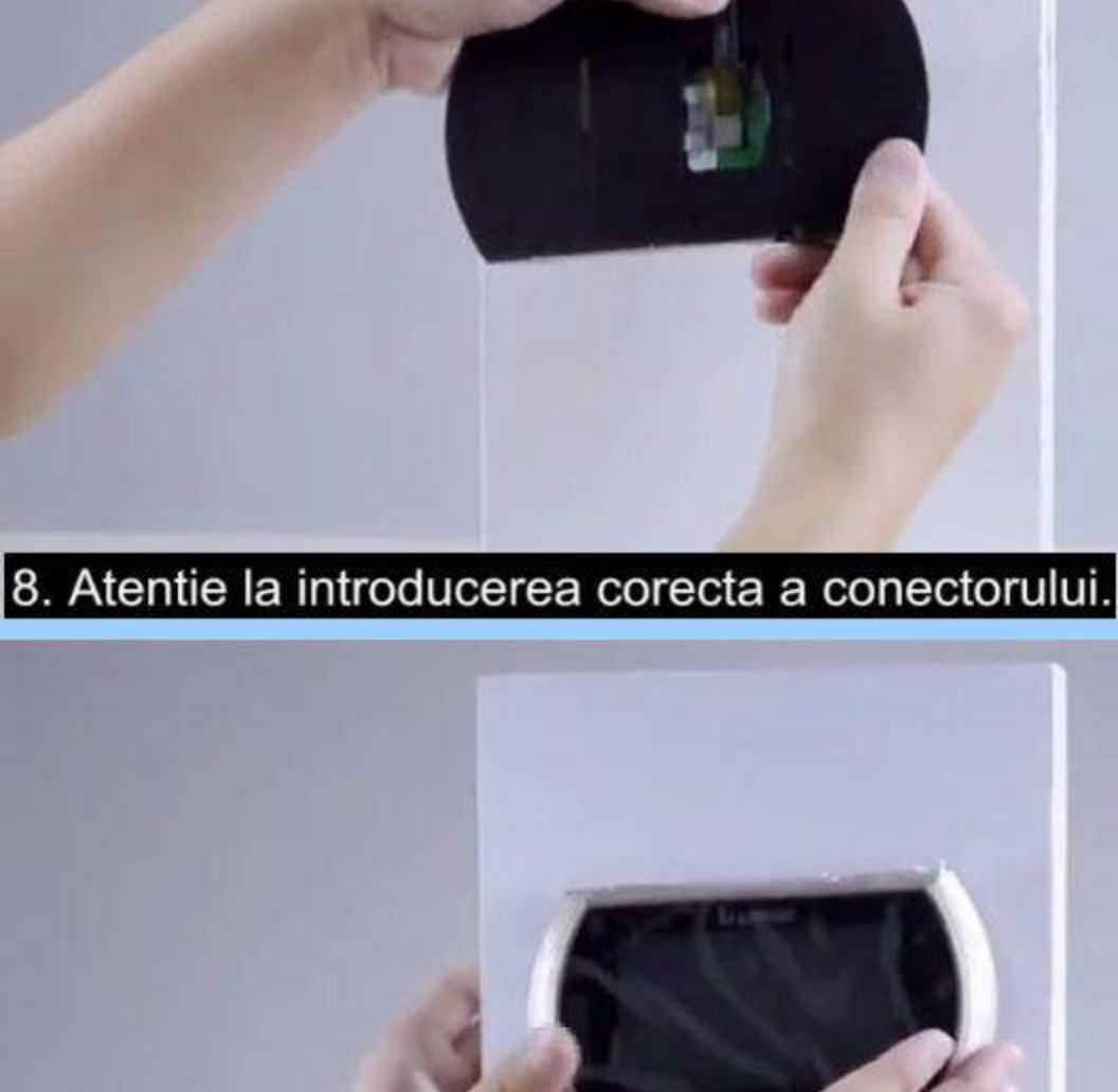
7. Se cupleaza cablul la conectorul displayului.
